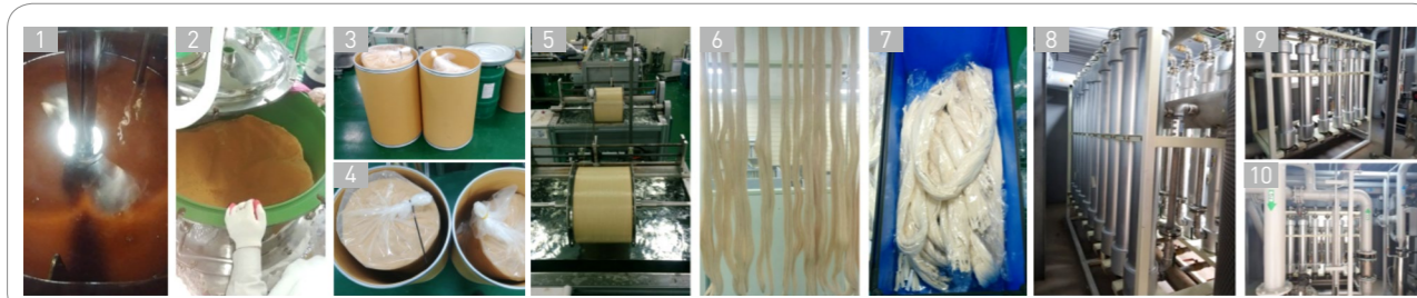
그림 1. 폴리이미드 합성 / 그림 2. 여과 / 그림 3&4. 대량합성 폴리이미드 / 그림 5. 폴리이미드 방사 / 그림 6&7. 후처리된 폴리이미드 중공사 / 그림 8-10. 4-6인치 대면적 중공사 분리막 모듈 skid
